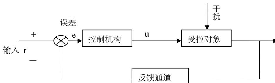
图 3 反馈控制结构图
