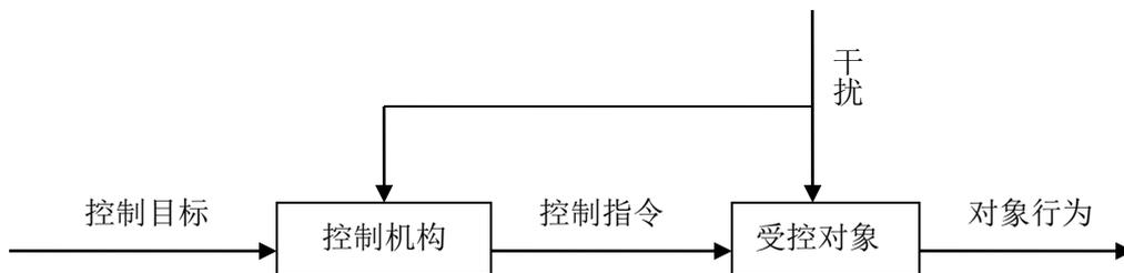
图 2 补偿控制结构图
